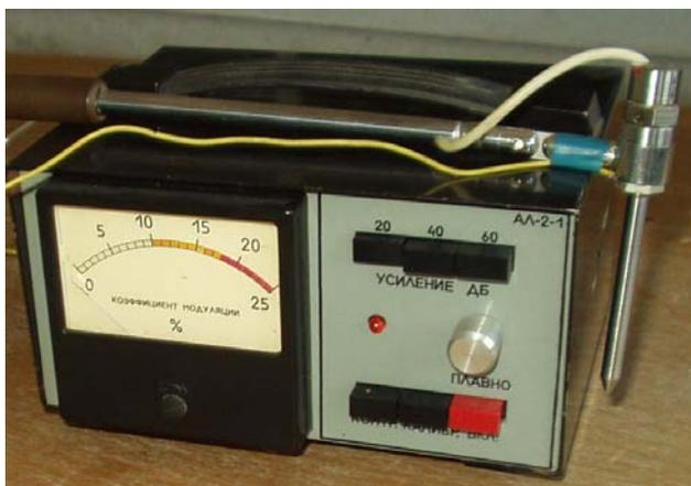
Рис. 4. Переносной прибор АЛ-2-1 для измерения коэффициента модуляции вибрации
